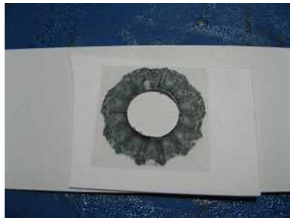
42.発動機部品の中心をスピナーの大きさに合わせてくり貫きます。
