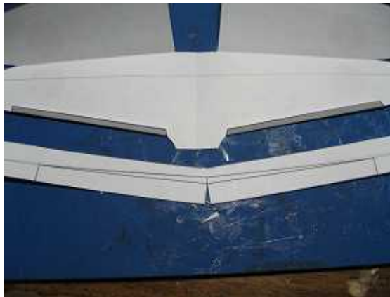
15.主翼桁部品を作ります。最初に主翼につける部分のみ切り出します。
