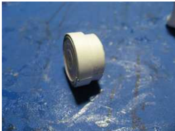
37.紙をまるめてきつめに胴体に入る太さにします。最後に5mmの紙を巻いて完成です。
