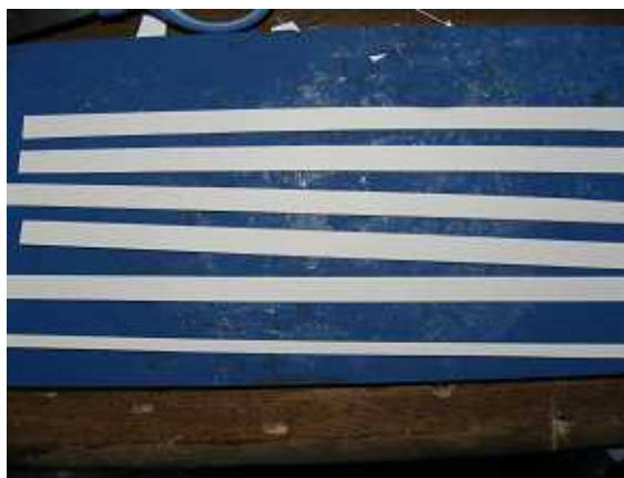
36.機首の錘、幅15mmを5本、5mmを1本A4縦の長さに切ります。お奨めは「コクヨ厚紙用紙」です。
